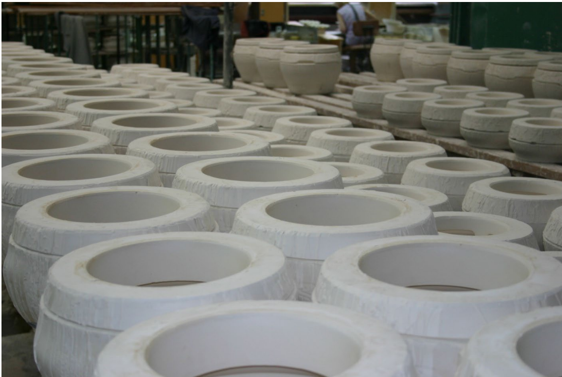
1. Formy gipsowe służące do odlewania kształtów z masy porcelanowej.
