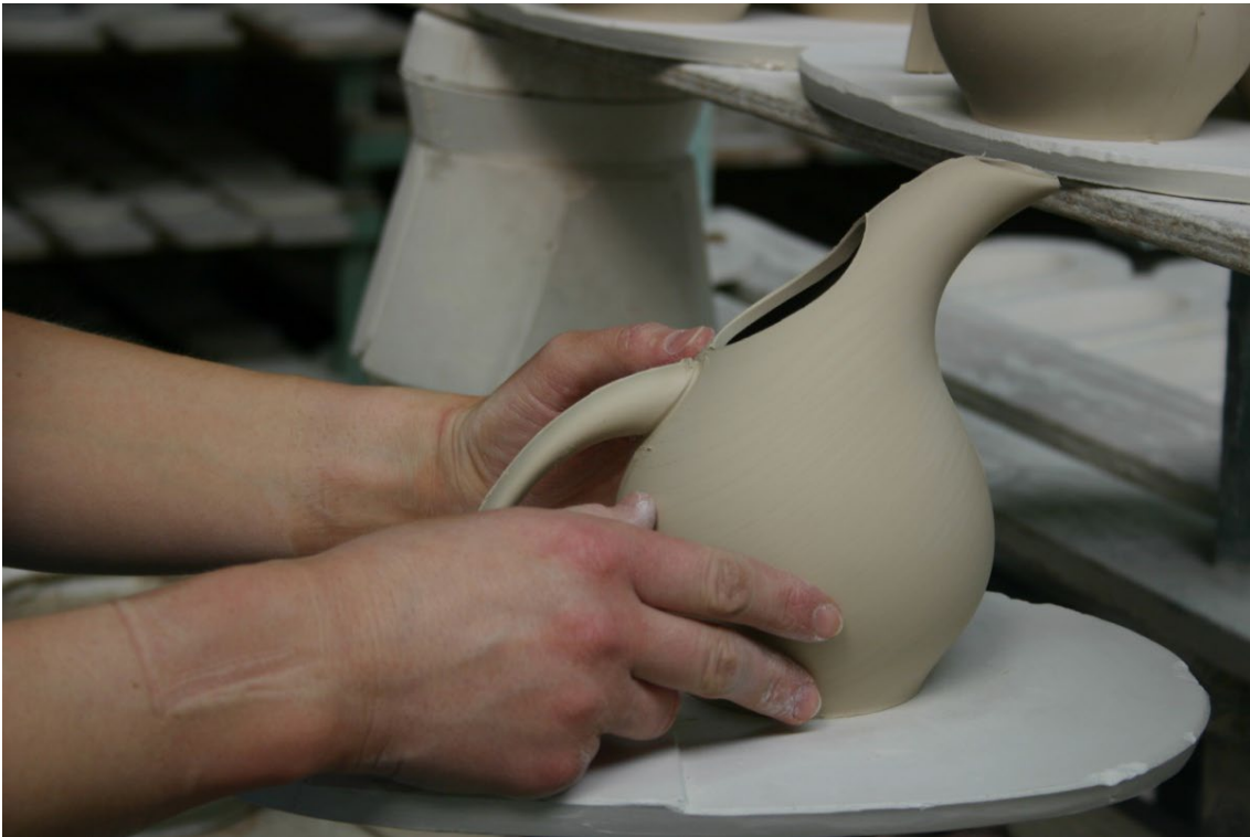
7. Ręczne wykańczanie naczynia z fasonu KROPLA
