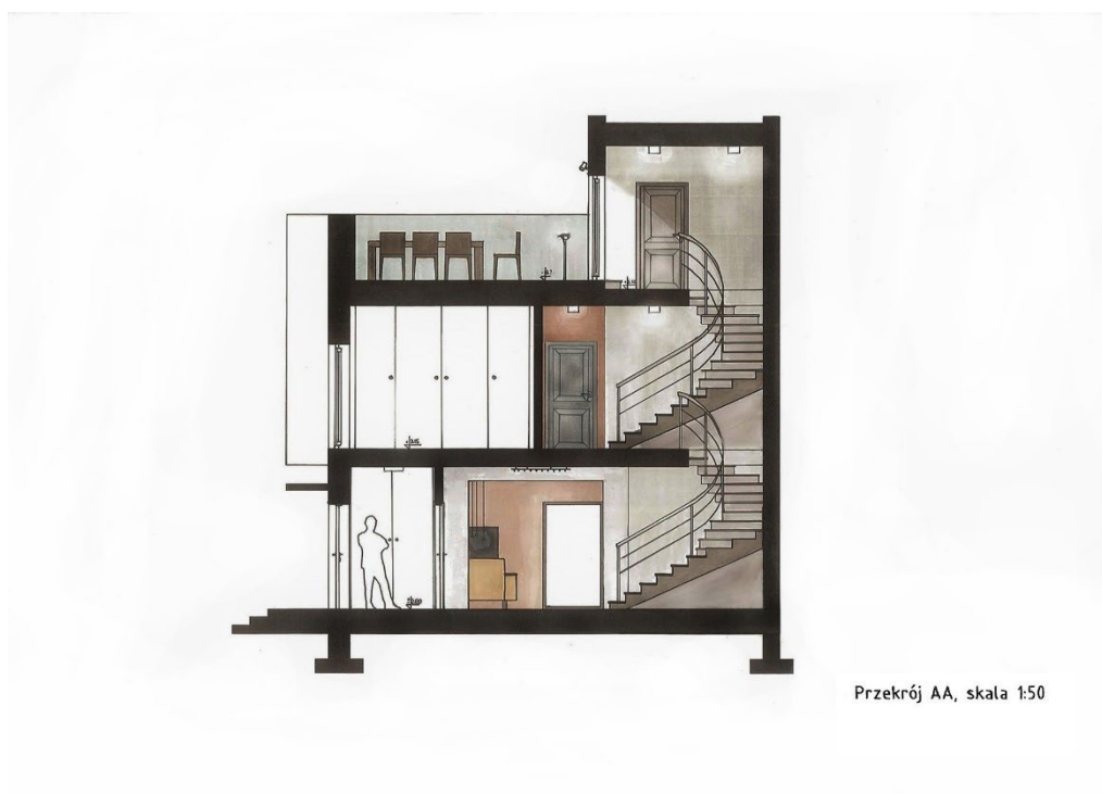
Fot. 6 Przekrój domu z układem funkcjonalnym
