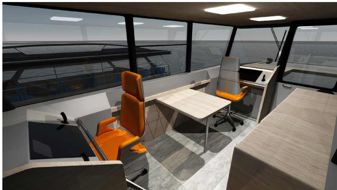
/ Sterówka promu wyposażona w dwa pulpity sterownicze i zaplecze socjalne dla załogi. Wizualizacja.
